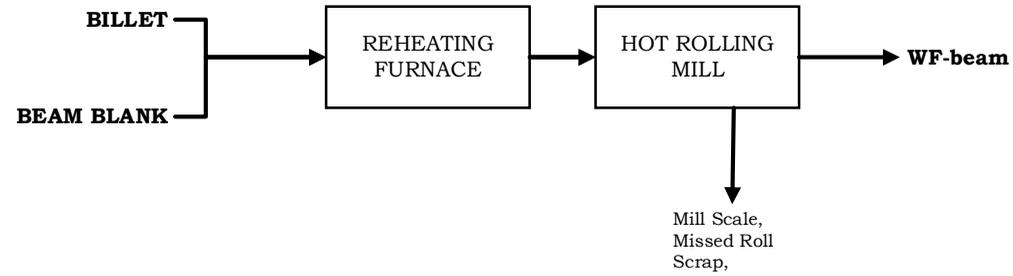
Gambar 5 – Bagan Alir Produksi Baja Profil WF-Beam
