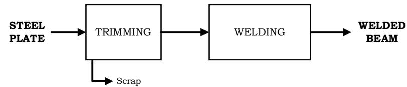
Gambar 8 – Bagan Alir Produksi Baja Profil *Welded Beam*
